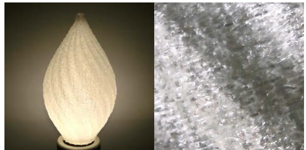
(a) 白化カバーつき電球 (b) 拡大写真
